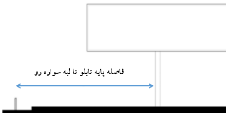
شکل 11 فاصله تابلو از حاشیه معبر
