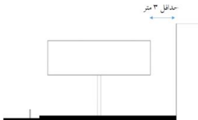
شکل 10 فاصله تابلو از کاربری مجاور معبر
